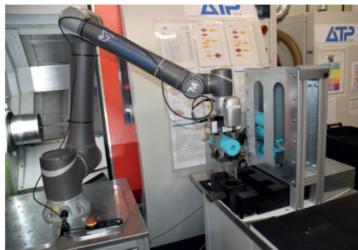
Vista del sistema d'automazione robotica di carico e scarico sviluppata e realizzata per ATP dal system integrator G.Engineering, sfruttando le potenzialità di un robot collaborativo Techman TM12, di cui il partner Sinta è distributore per l'Italia.
