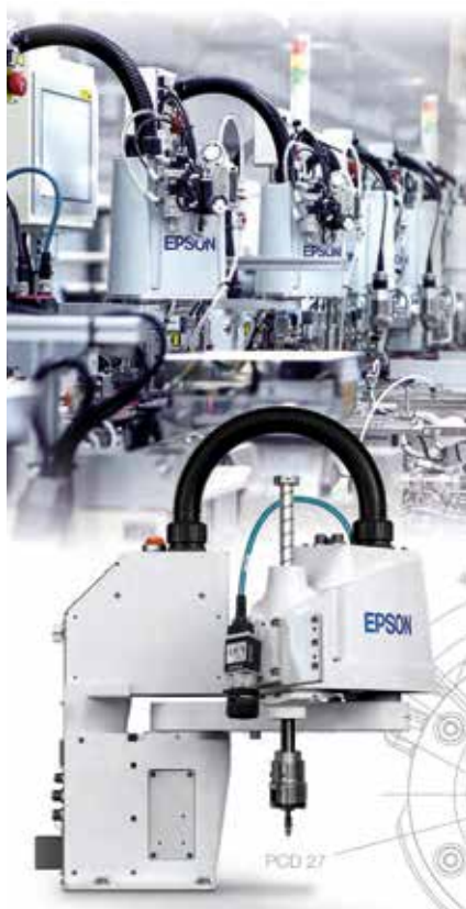
Robot SCARA EPSON serie T con controller integrato.
