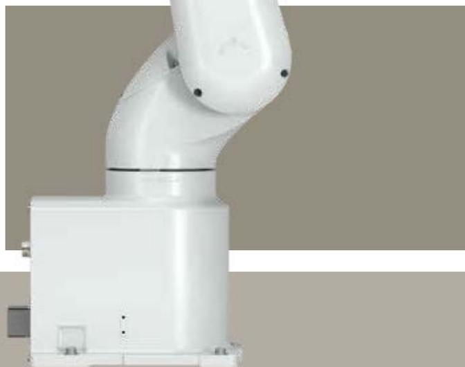
Il robot EPSON VT6-L non possiede back-up delle batterie per gli encoder, ma ha encoder assoluti multigiro di ultima generazione.
