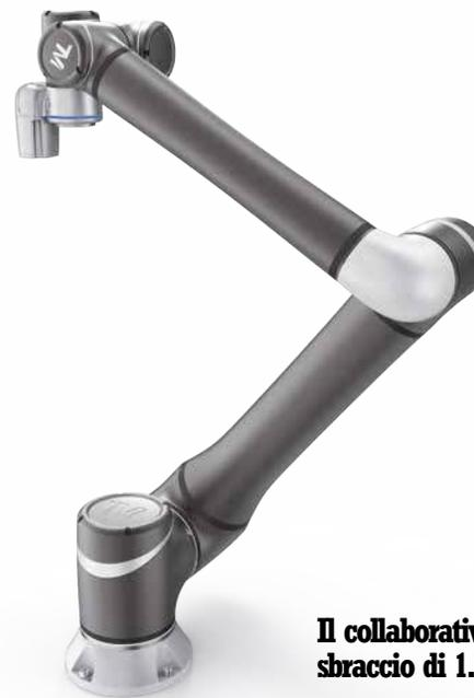
**Il collaborativo Techman TM12, dotato di uno sbraccio di 1.300 mm e una capacità di carico di 12 kg.**
